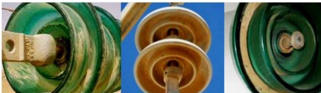
Fig. II. 1: Couche de pollution sur des isolateurs en silicone et en verre [55]
