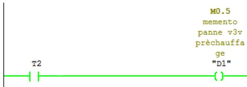
Figure III.33 : Réseau de la panne de préchauffage.
