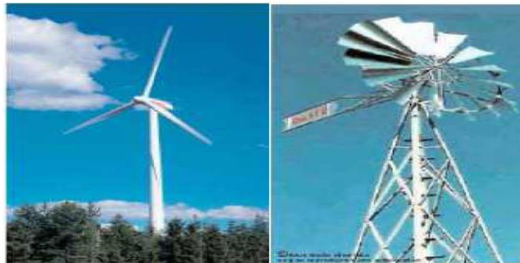
Figure 6 : Eoliennes à axe horizontal
