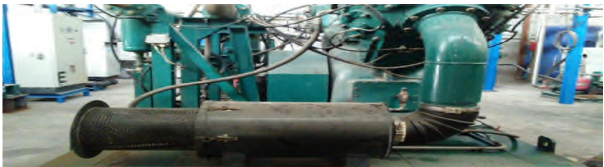
Figure II.11 : Filtre à air.
