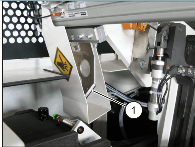
Figure II.17 Système de coupe transversale avec lame [5]
