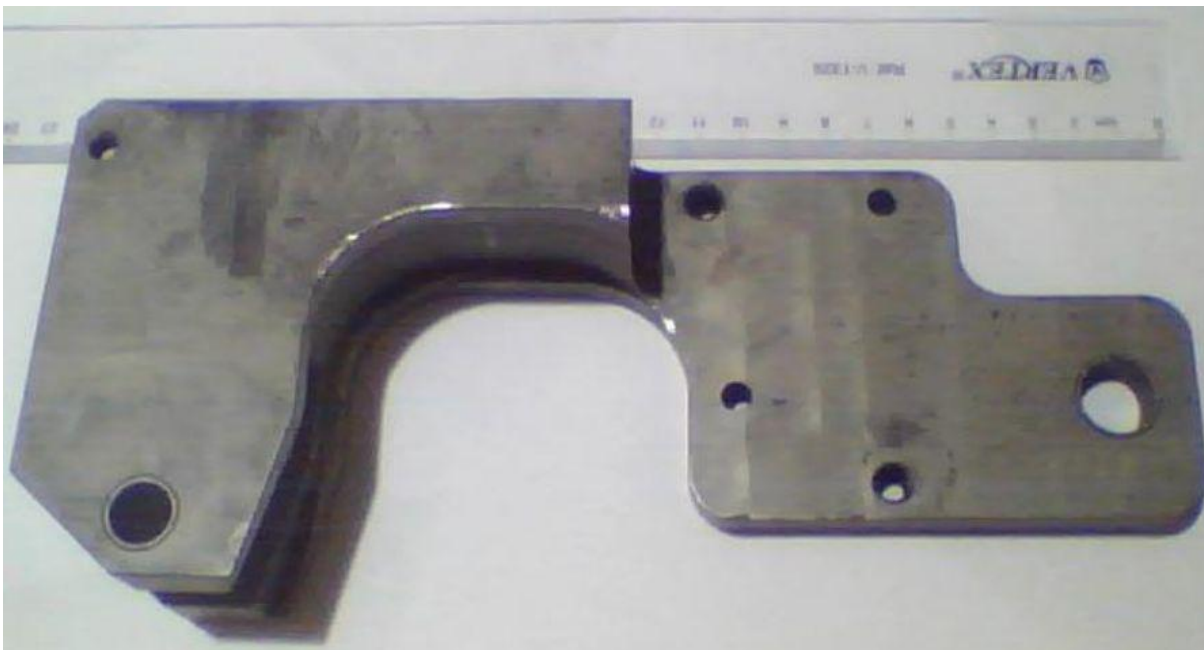
Figure II.14 Le premier support porte arbre de bobinage Fissuré
