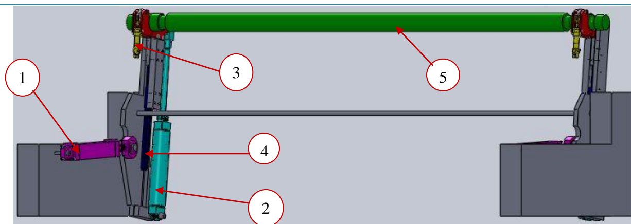
Figure III.1 Système de changement de bobine de l'enrouleur optimex
