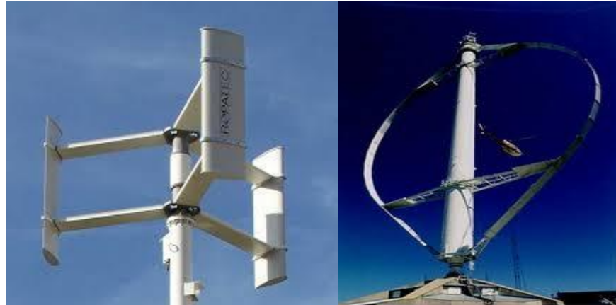
Figure I.3 : Eolienne à axe vertical type « Darrieus ».
