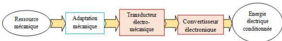
Figure I.6 : Principe de conversion électromécanique
