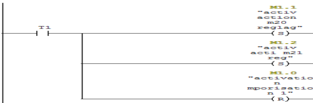
Figure II.15 : Deuxième étape de réglage des deux moteurs longitudinaux.
