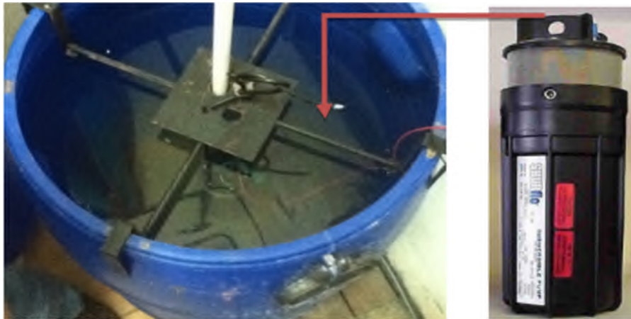
Figure III.5 : Groupe motopompe immergée.
