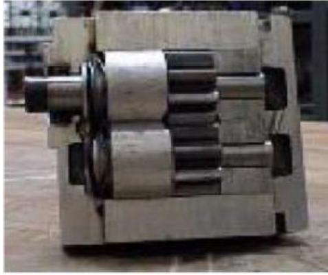
Figure I-24 : Moteur à engrenages.
