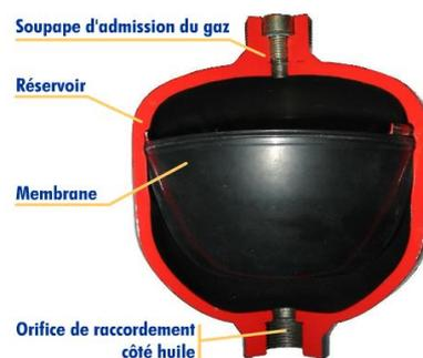
Figure I-30 : Accumulateur à membrane.
