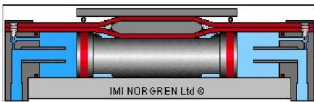
Figure II- 30 : Vérin double effet sans tige avec amortissement des deux côtés
