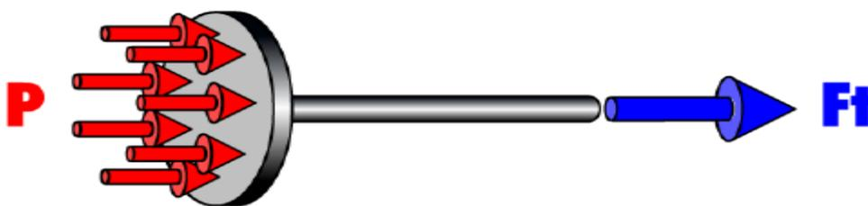
Figure II-35 : Schéma de principe calculant la poussée d'un vérin.
