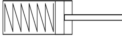
**Figure II- 22 :** Symbole d'un vérin simple effet en tirant [18]
