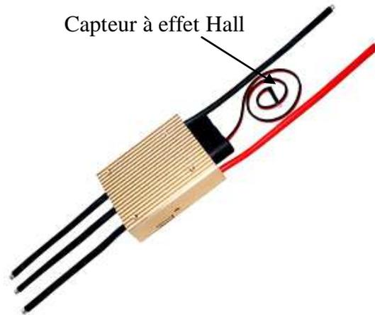
**Figure I.20.** Contrôleur de vitesse(ESC) avec capteur à effet hall [30].
