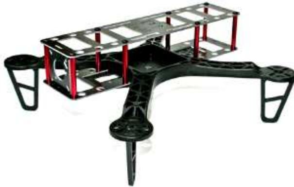
**Figure I.15.** Châssis d'un quadri-rotors en (x) [22].
