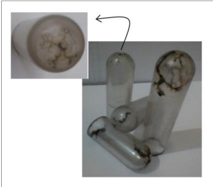
**Fig. IV.30** : Image montrant le phénomène d'arborescence apparu sur nos tubes durant les essais
