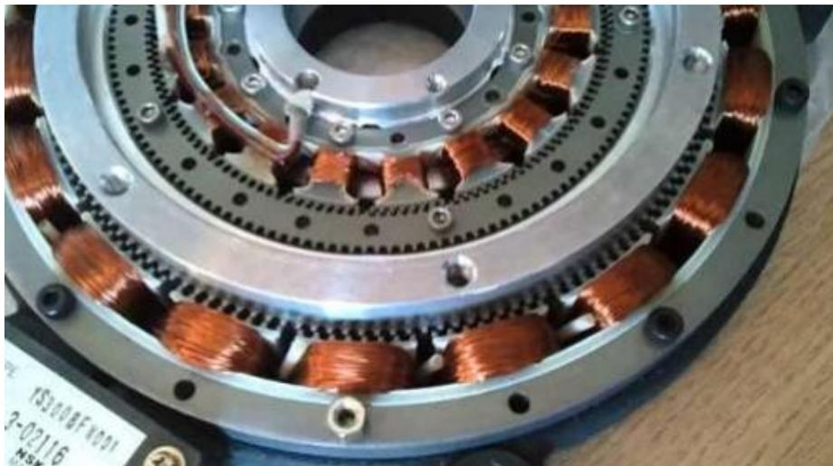
Fig. I.2. MRV à effet vernier à stator externe et interne
