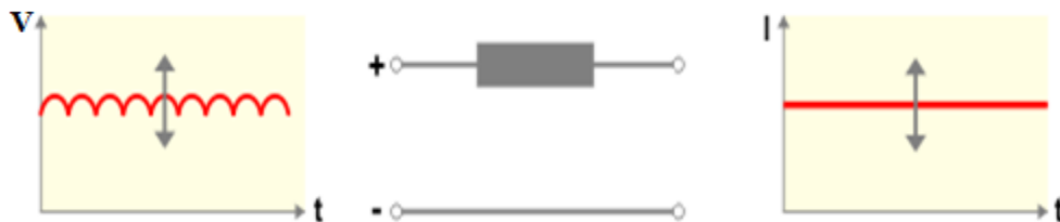
Figure II.8 : Circuit intermédiaire à courant continu variable
