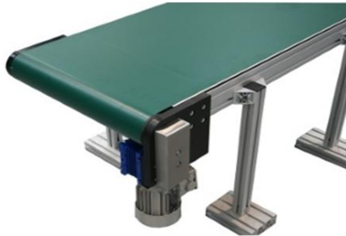
Figure I.12: Entraînement avec un moteur en dessous
