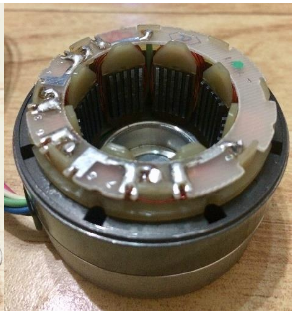
Fig.III.8-Moteur pas à pas hybride utilisé
