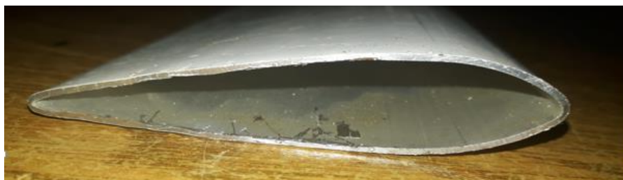
Fig. III.5-Profil de la pale réalisée
