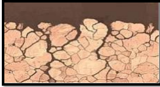
Figure I.5 : corrosion sous contrainte [17].
