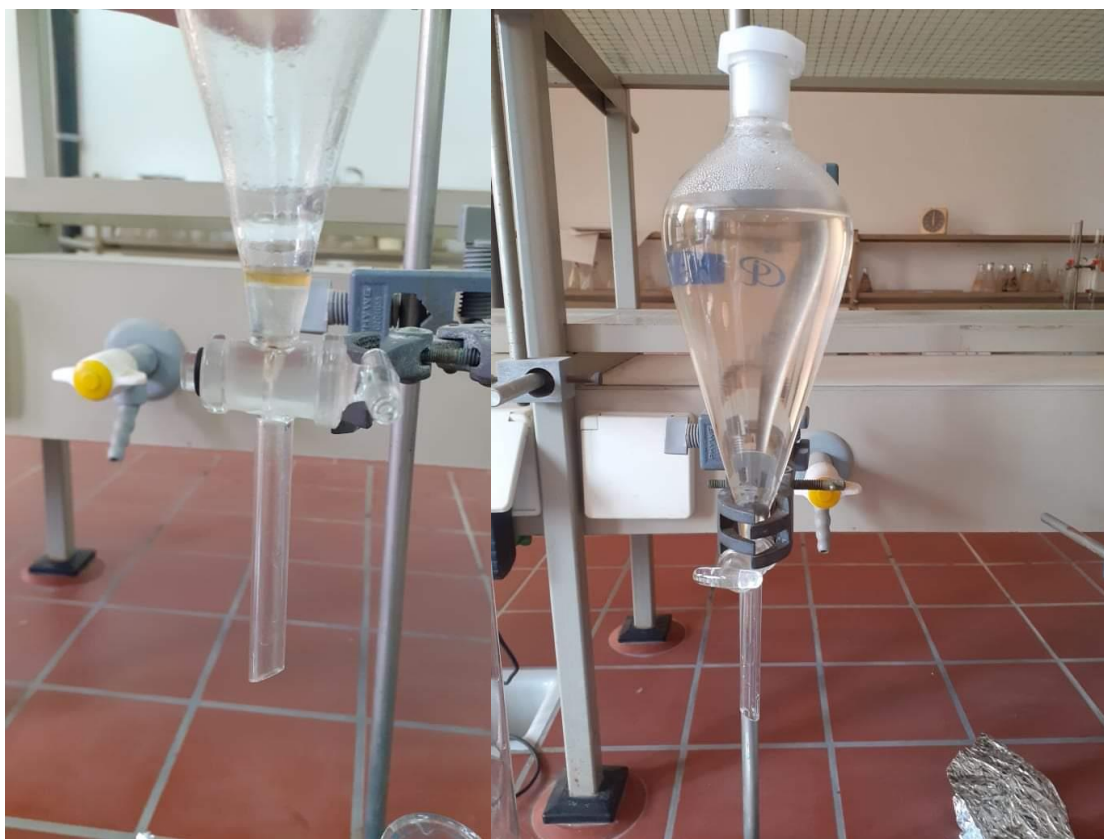
Figure IV.5 : Montage de la décantation.
