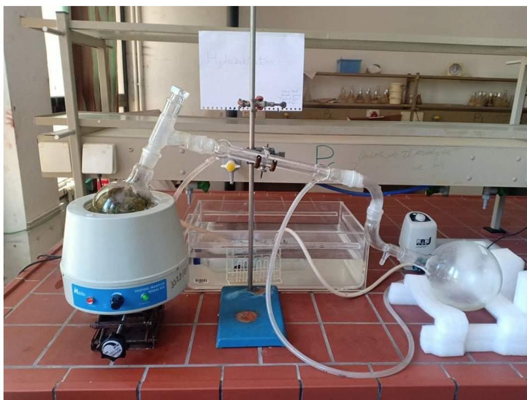
Figure IV.4 : Montage de l'hydrodistillation.
