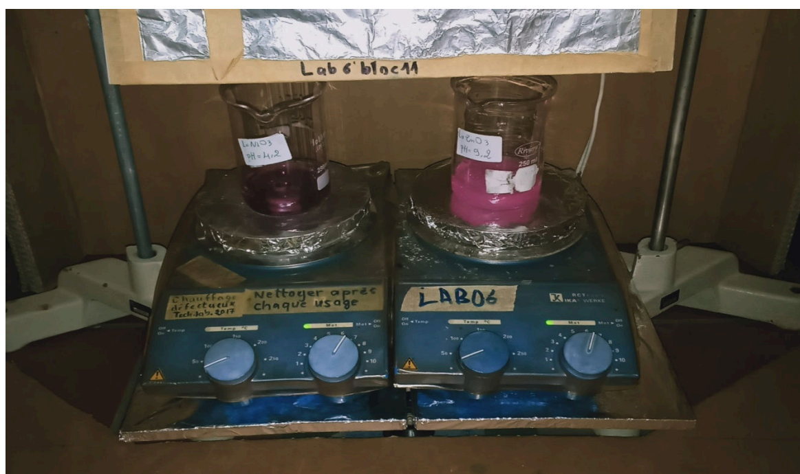
Figure II.1 : Montage utilisé pour la dégradation de la Rhodamine B.
