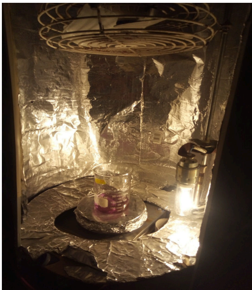
Figure II.2 : Montage utilisé pour la dégradation du la Rhodamine B dans visible.
