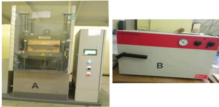
Figure II.3 : A) Une presse hydraulique de marque CAVER INC, B) L'étuvage de marque BINDIRE
