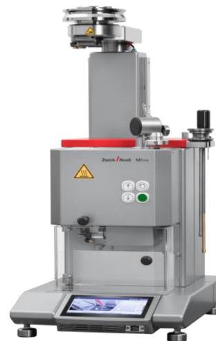
Figure II.7 : Machine de la fluidimètre MFLOW/ZWICK
