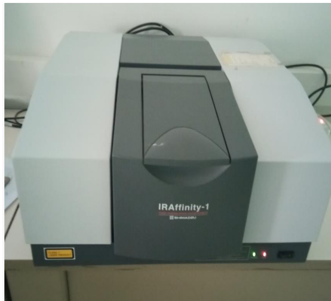
Figure II.4 : Spectromètre à transformée de Fourier de marque Affinity-1 SHIMADZU
