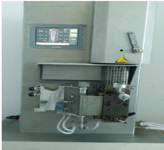
Figure II.2 : l'extrudeuse DSM XploreNetherlands
