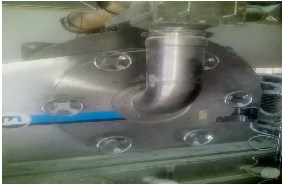
Figure.III.16. Photographie de l'unité de broyage « Broyeur Poly Mill UM 630 »
