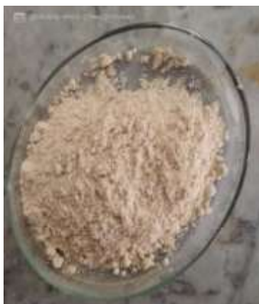
Figure III.3 : sciure de bois après broyage et tamisage à l'état brute
