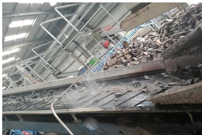
**Figure 2.38 :** Lavage des morceaux de pneus sur le tapis convoyeur
