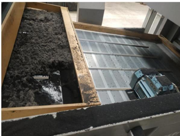
**Figure 2.43 :** Photographie du nettoyeur fin
