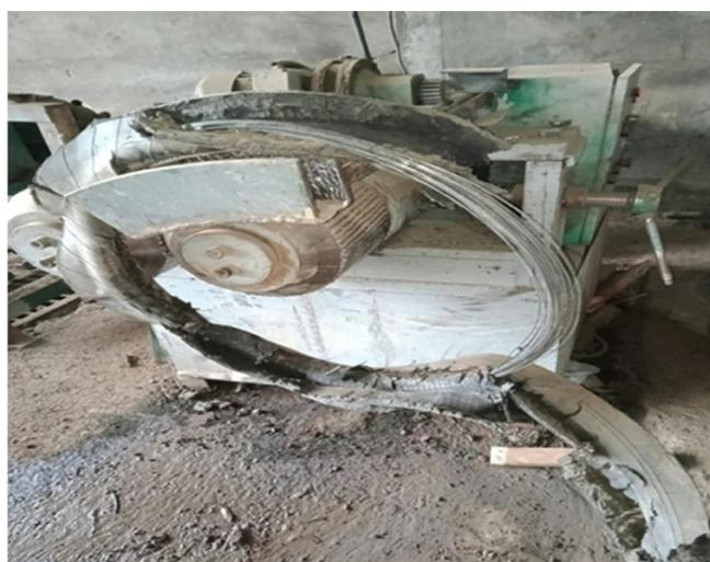
Figure 2.33 : Séparation de la tringle enrobée dans la gomme
