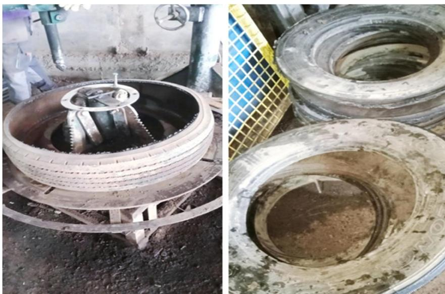
Figure 2.31 : Flancs séparés de pneus
