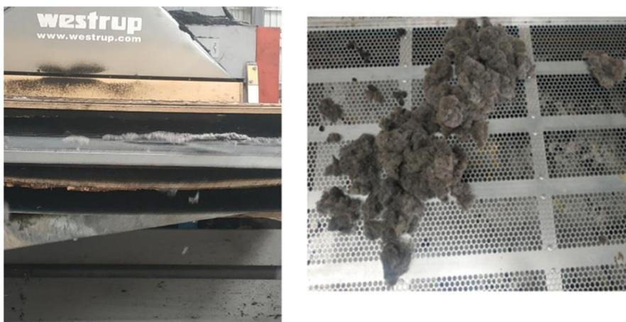
Figure 2.42 : Tables à fibres de séparation textile / caoutchouc
