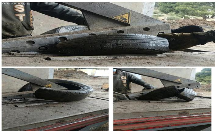
Figure 2.36: Découpeuse de pneus
