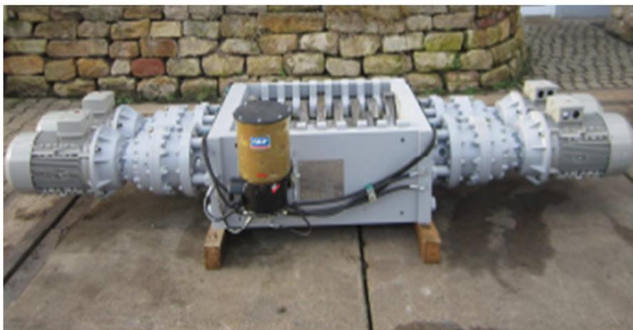
**Figure 2.39 :** Photo réelle de la partie supérieure d'un broyeur
