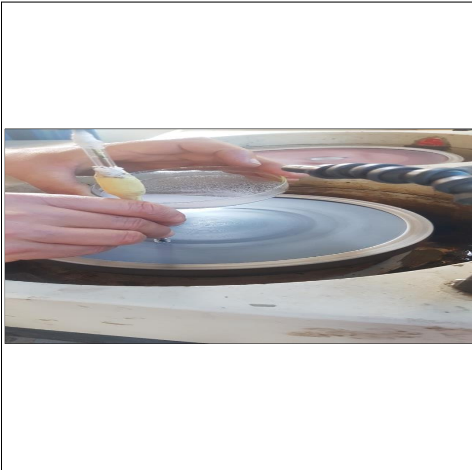
Figure IV.5 : Opération de polissage de l'électrode
