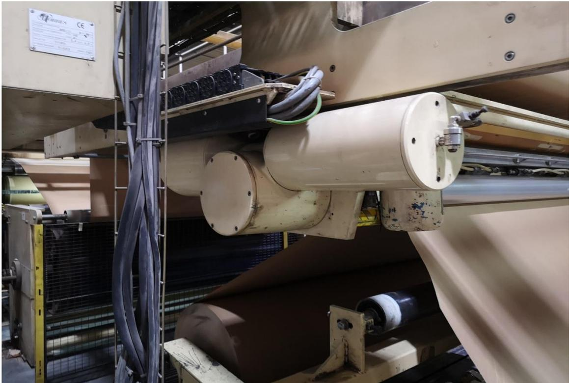
**Figure.I.4 :** Vue du vérin rotatif à quatre actions
