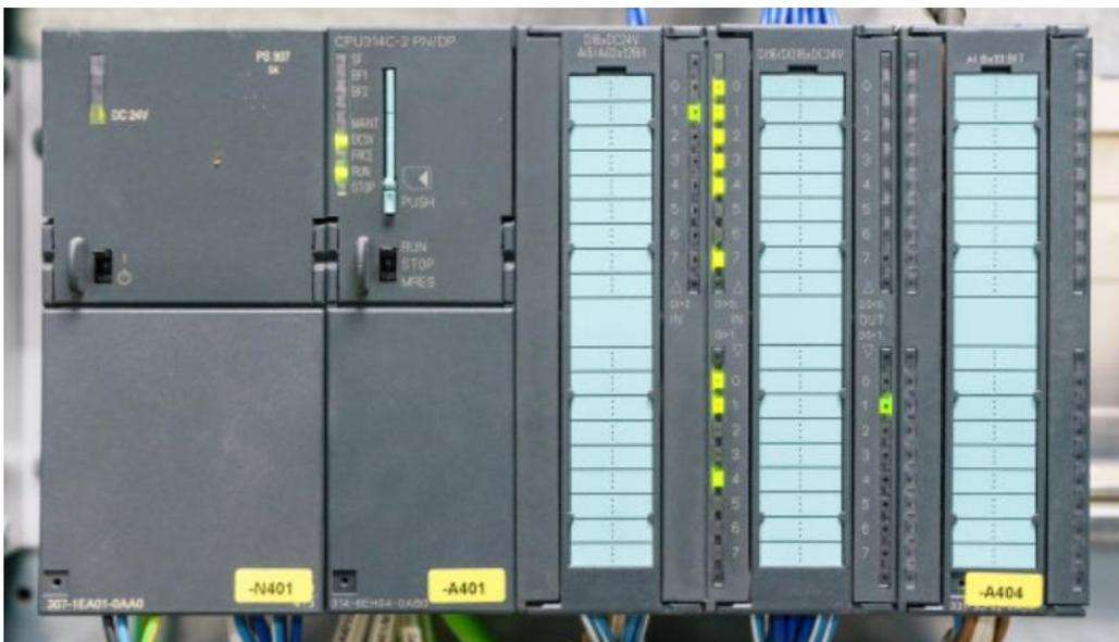
Figure.III.1: Vue d'un automate S7-300
