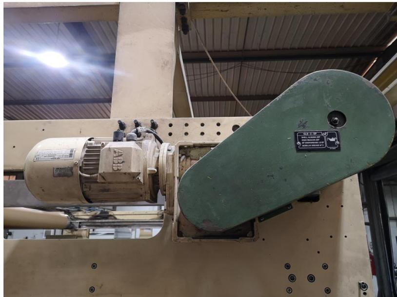
Figure.I.6: Moteur et embrayage du feston
