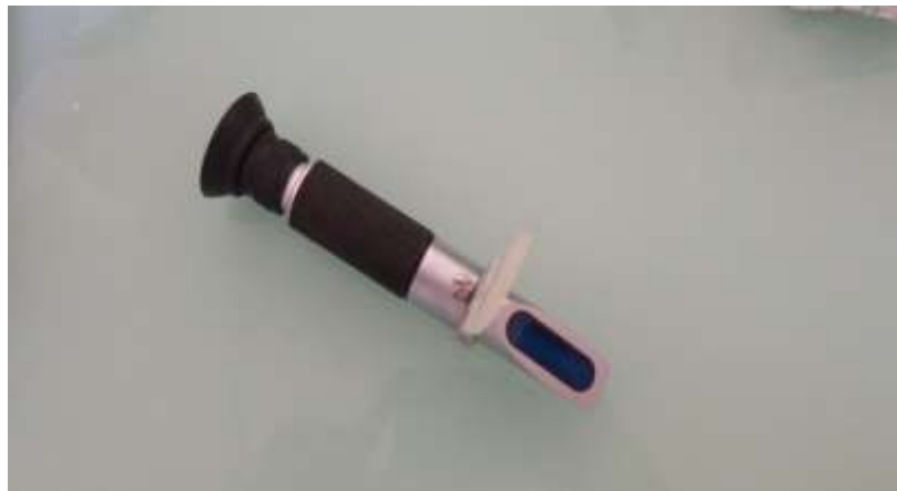
Figure 15 : Une photographie du réfractomètre pour analyse du Brix
