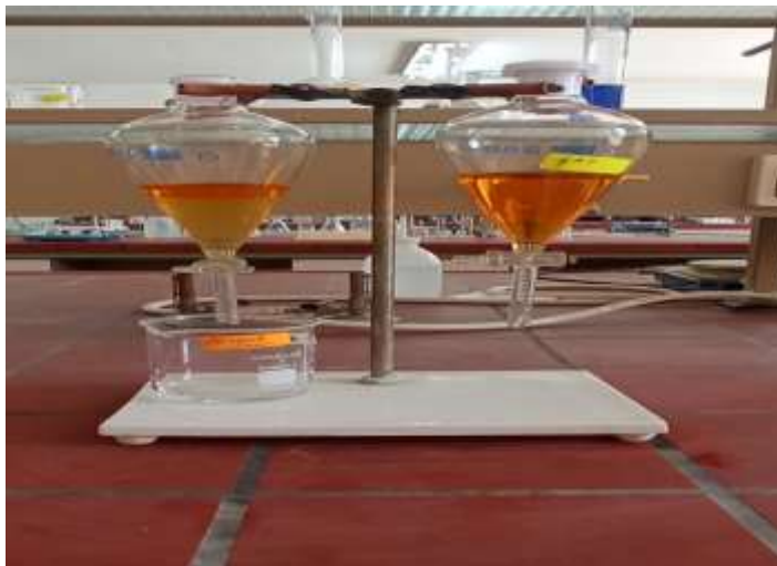
Figure 18 : Séparation des phases
