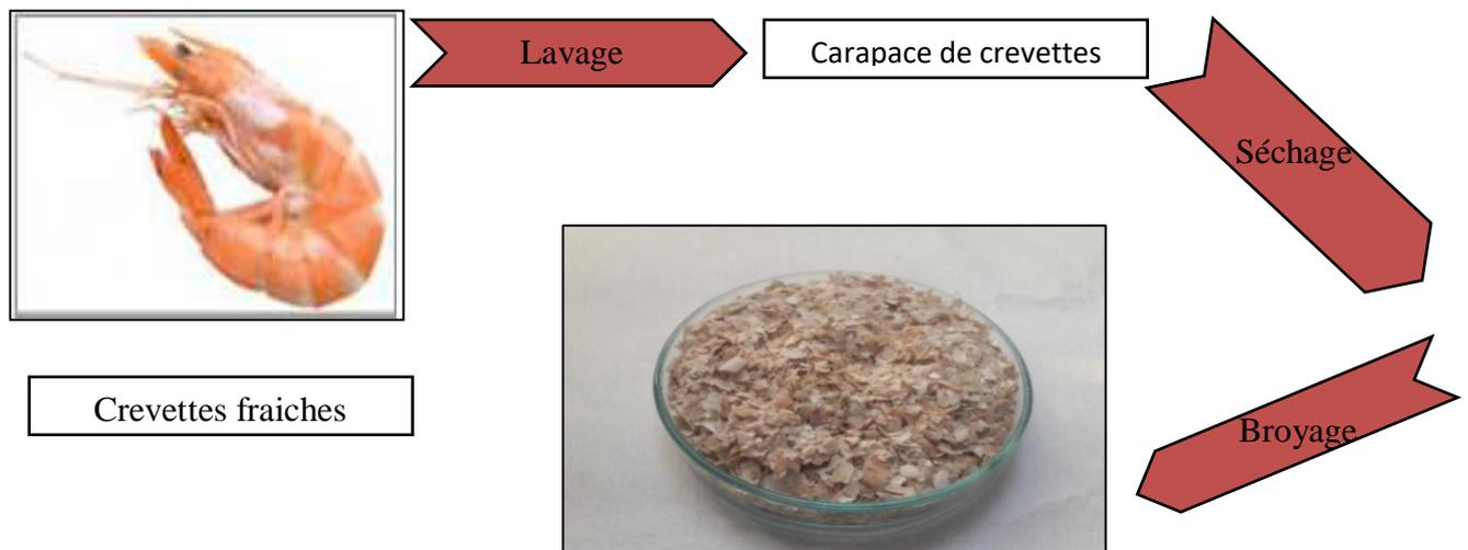
**Figure 4.** Schéma du prétraitement des carapaces de crevettes.
