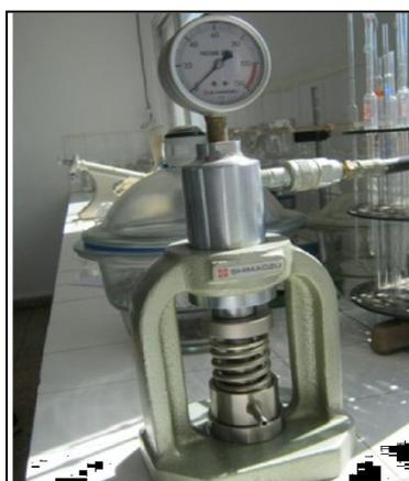
**Figure 11.** Presse hydraulique SHIMADZU .
