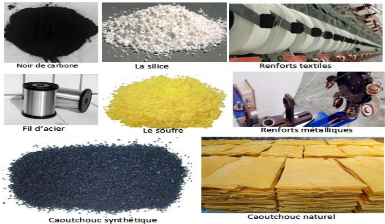
Figure II-6 : Matériaux qui rentrent dans la composition d'un pneu
