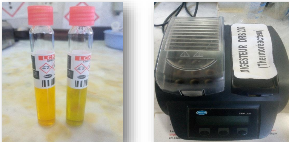
Figure II.7 : La mesure de la DCO.
