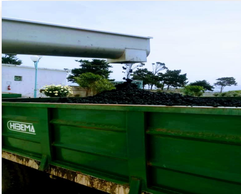
Figure I.9 : Transport de la boue déshydratée.
