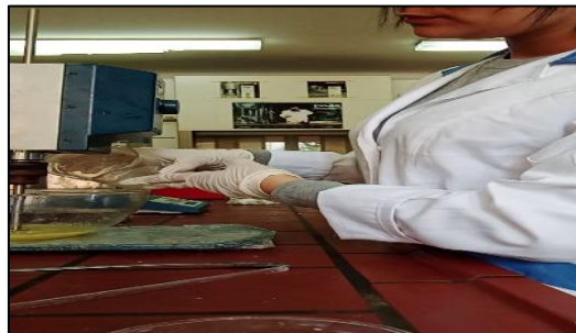
Figure 31: ajout de la solution de soude/lait au mélange des huiles
