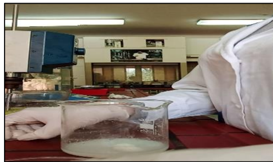
Figure 30: ajout de lait de chèvre à la solution de soude
