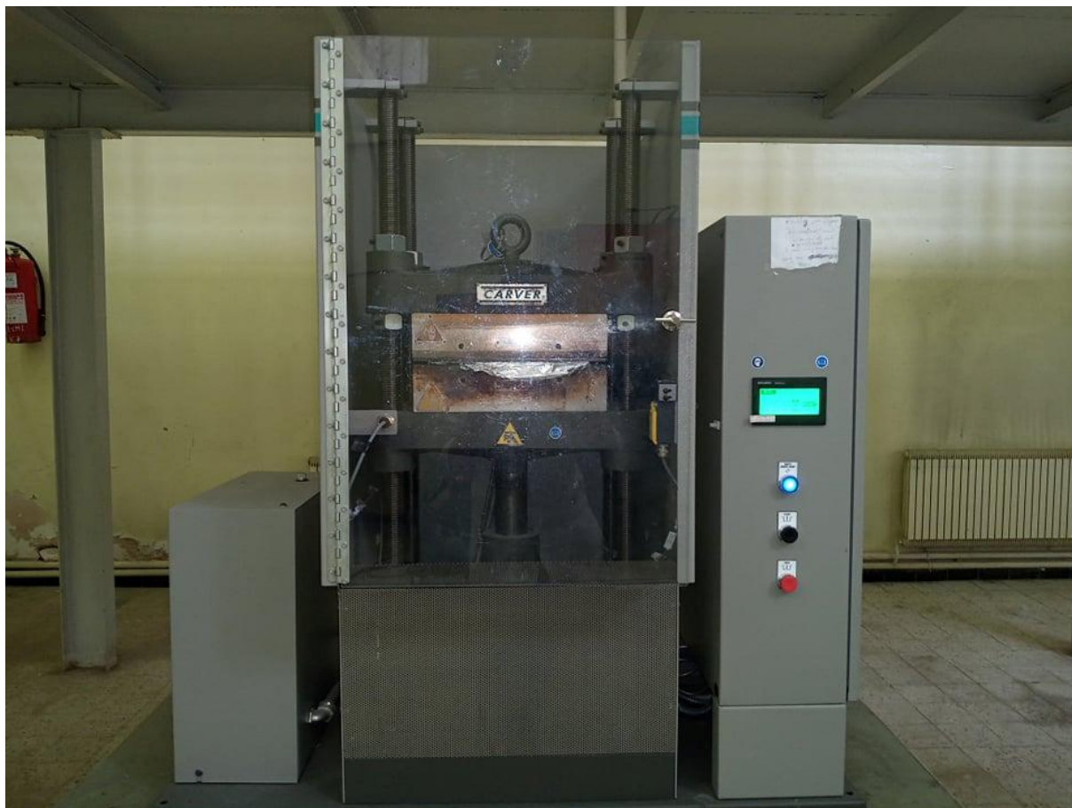
Figure III.4. Photo d'une presse hydraulique pour la préparation des films et éprouvettes.
