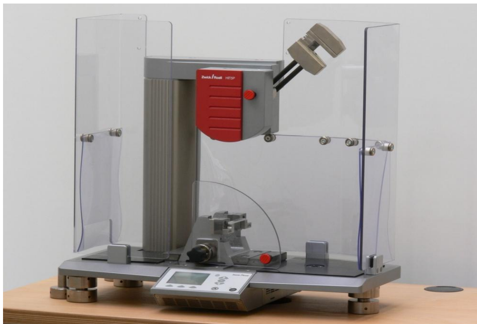
Figure III.9. Appareil d'essai de choc Izod (ASTM D4812).
