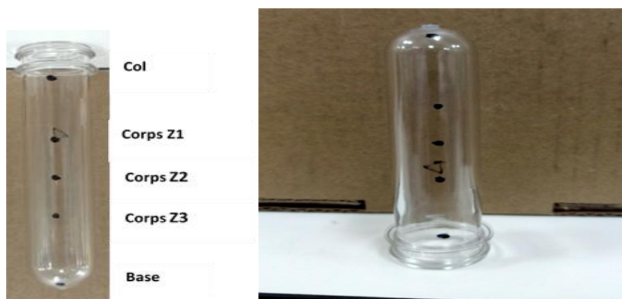
Figure V.10 : Les déférentes répartitions d'épaisseur d'une préforme de 24g.
