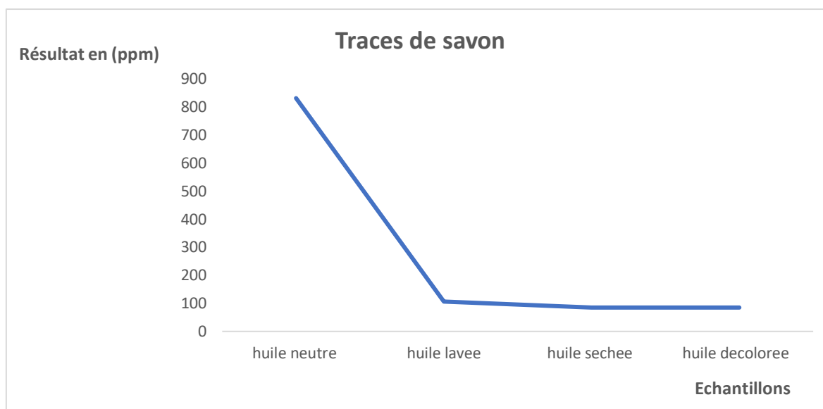
Figure IV.3 : Evolution de la teneur en traces de savon des différents échantillons d’huile de soja.
