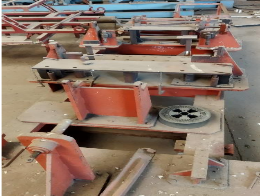
Figure 13 :Gabarit d'assemblage de châssis d'une Epandeuse
