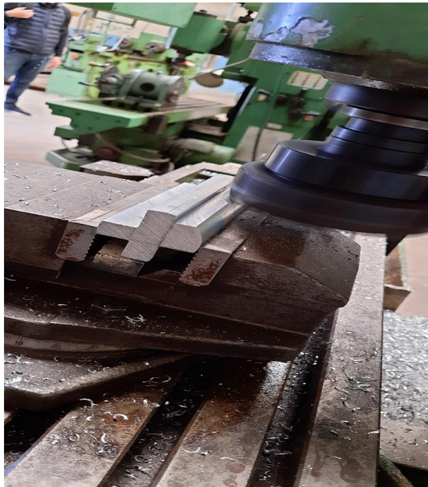
Figure III.4 Méthode d'usinage sur la fraiseuse.
