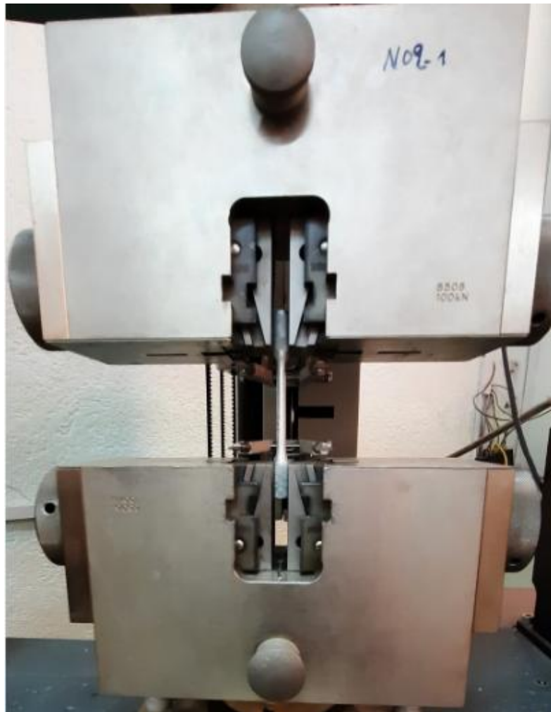
Figure III.8 éprouvette de traction avant la rupture.
