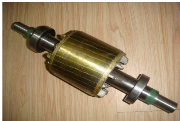
Figure I. 6 -Rotor à cage
