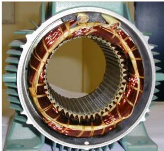
Figure I. 2-Stator d'un moteur asynchrone
