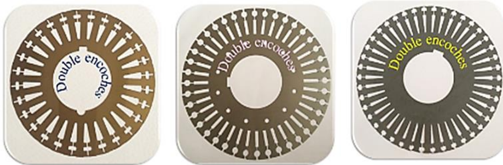
Figure I. 8- Tôle magnétique à double cage
