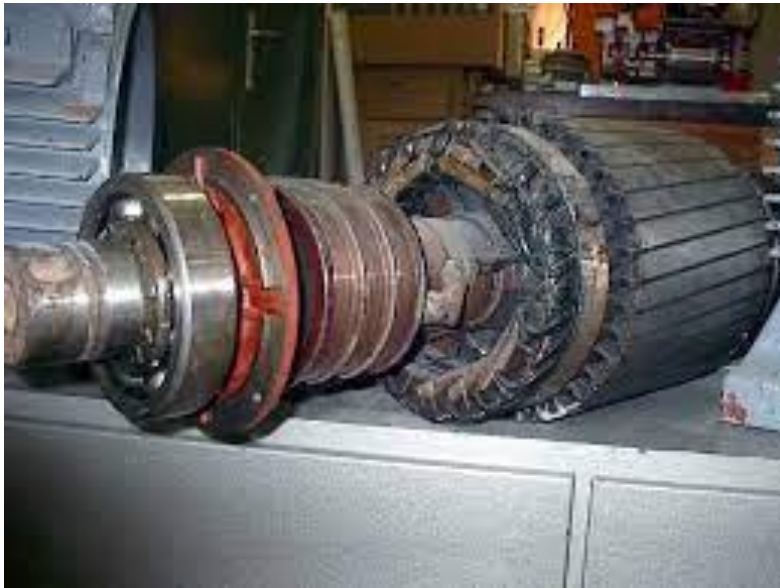
Figure I. 3 -Rotor bobiné d'un MAS
