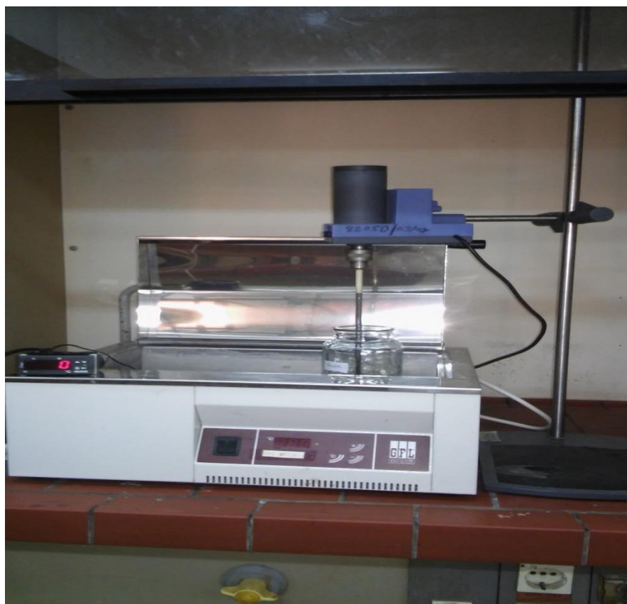
Fig. III.1. Montage de synthèse de l'OG par la méthode d'Hummers modifiée.
