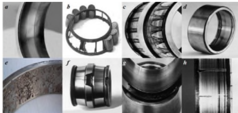
Figure I. 10 Quelques défaillances affectant les roulements a- Usure généralisée b- Cage détériorée c-Corrosion d- Présence de cratères e- Écaillage f- Fissure et cassure g- Grippage h- Traces d'empreintes.
