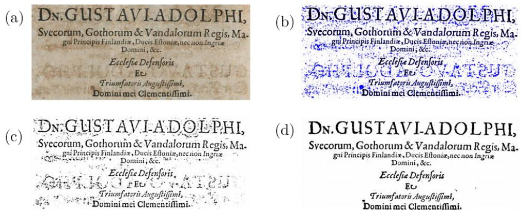
Figure 1.5. Binarisation d'images avec un CRF, (a) image originale, (b) image pré-binarisée (pixels incertain en bleu), (c) image binarisée avec la méthode de Sauvola, (d) binarisation optimisée par un CRF [36].
