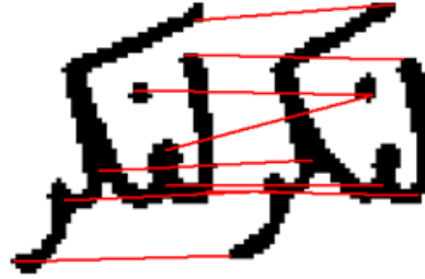
Figure 3.13. Un exemple des matchs des points-clés d'une CC dans une autre CC.
