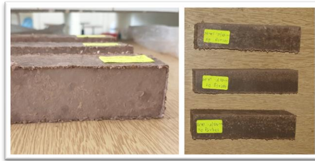
Figure 2. 21: Eprouvette avec ajout après démoulage
