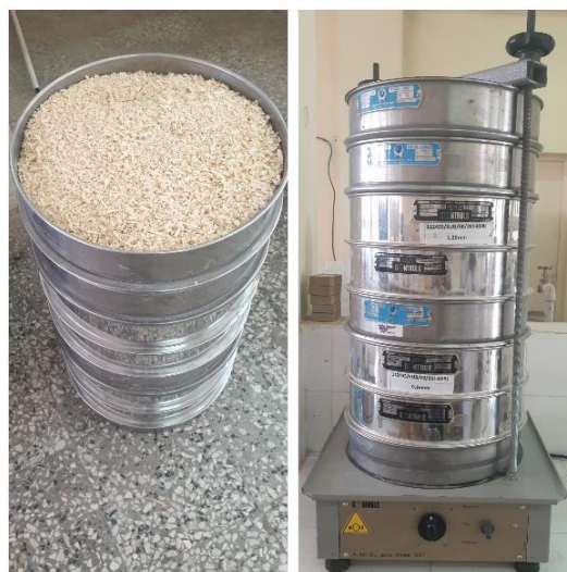
Figure 2. 15 : Dispositif de classification des copeaux de bois
