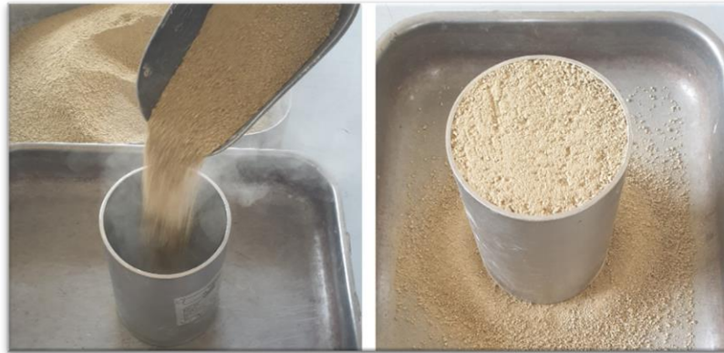
Figure 2.12 : Dispositif de détermination de la masse volumique en vrac
