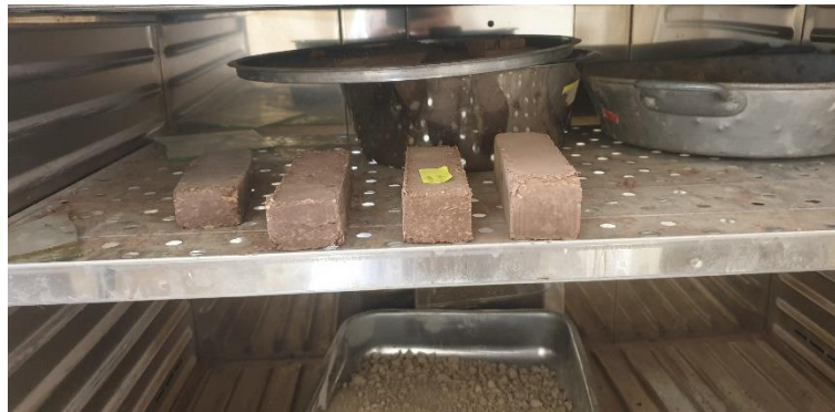
Figure 2. 22 : Séchage dans une étuve à 50°C
