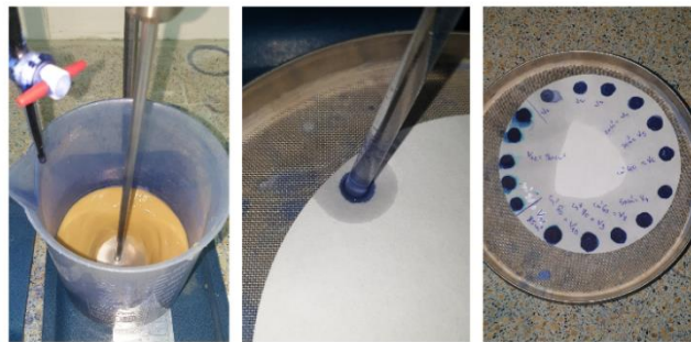
Figure 2. 8 : Détermination de la valeur au bleu de méthylène du sol
