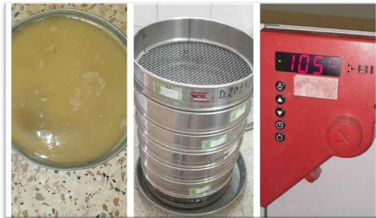
Figure 2. 6 : Dispositif de tamisage par voie humide
