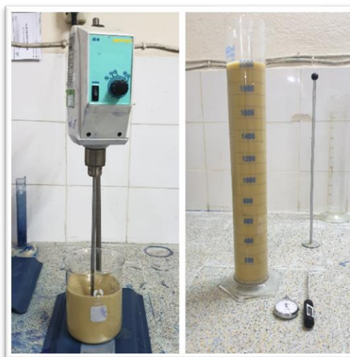
Figure 2. 7 : Dispositif d'analyse granulométrique par sédimentation
