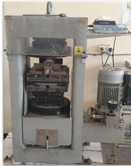
Figure 2. 19 : Pressage des éprouvettes
