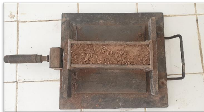
Figure 2. 18 : Moulage des éprouvettes
