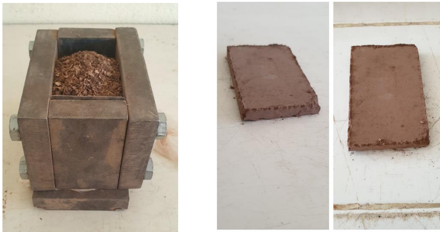
Figure 2. 24 : Moule et brique utilisé pour le teste de conductivité thermique
