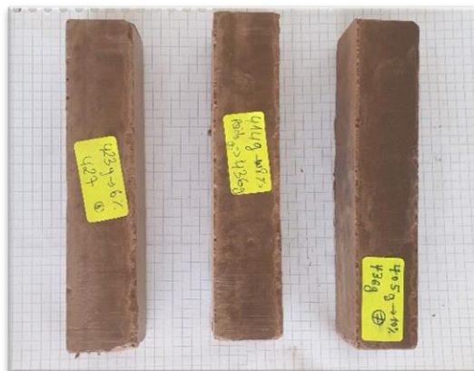
Figure 2. 20 : Eprouvettes sans après démoulage
