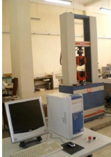
Figure 2. 26 : Machine d'essais IBERTEST
