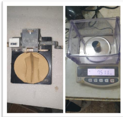
Figure 2. 10 : Appareil de Casagrande
