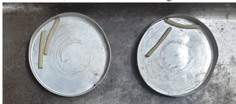
Figure 2. 11 : Dispositif de détermination de la limite de plasticité
