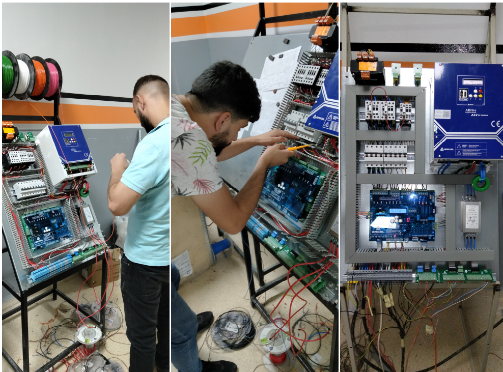
Figure IV-5 : Exemple du câblage
