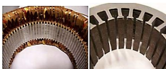
Figure I-12 : Stator avec et sans bobinage.
