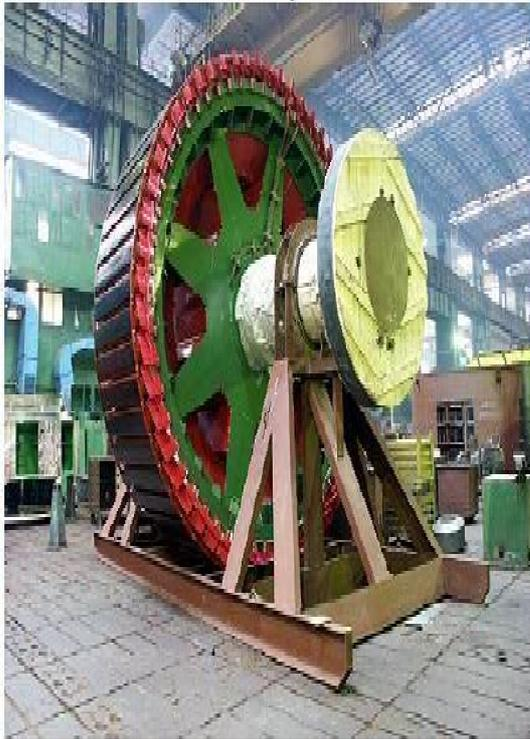
**Figure I.2 :** Rotor avec 9 phases d'un hydro générateur synchrone.
