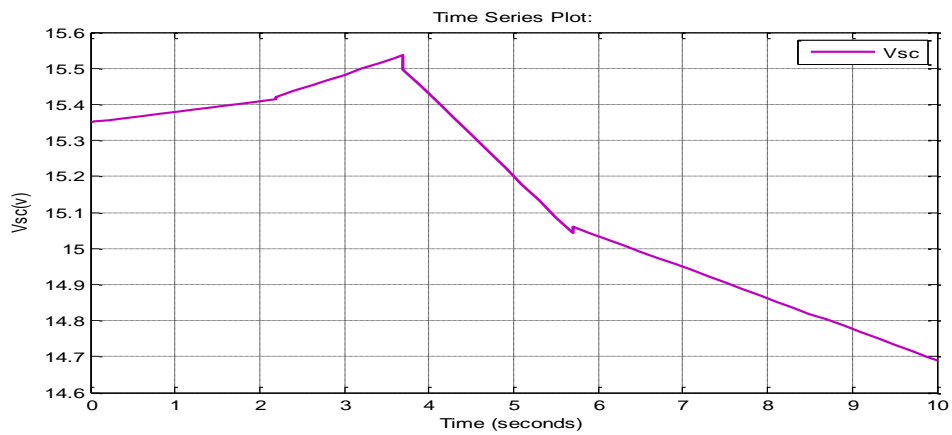
Figure II.3 : Tension aux bornes du super condensateur
