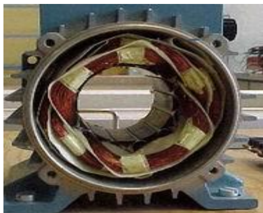
Figure I.1 : Le stator d'une machine asynchrone
