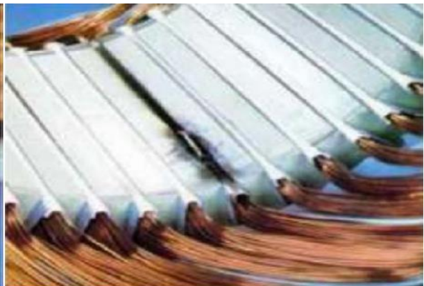
Figure I.7: Masse dans l'encoche
