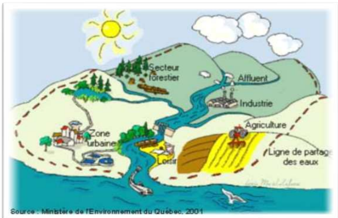
Figure (I.1) : Schéma d'un Bassin versant avec une ligne de crête, un cours d'eau principale, des affluents et un exutoire. (Source : Ministère de l'Environnement du Québec. 2001)
