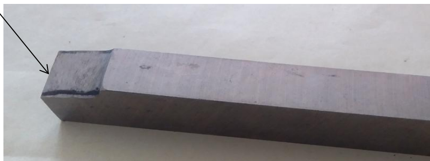
Figure III.3: Réalisation d'un angle de dépouille ( \alpha ) sur un barreau en ARS.
