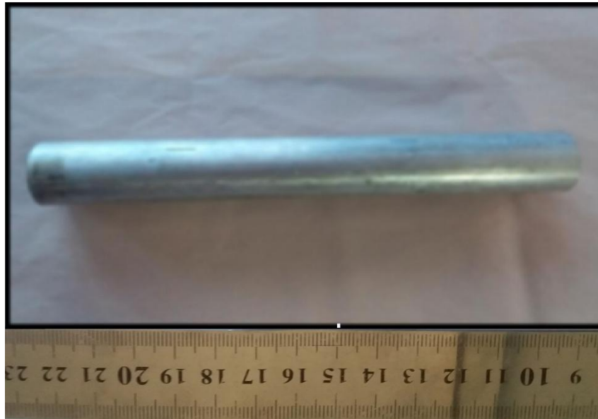
Figure III.6: Cylindre plein en Aluminium de diamètre 50 mm.
