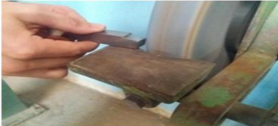
Figure III.5: Réalisation de l'un des angles de l'outil de coupe en ARS.
