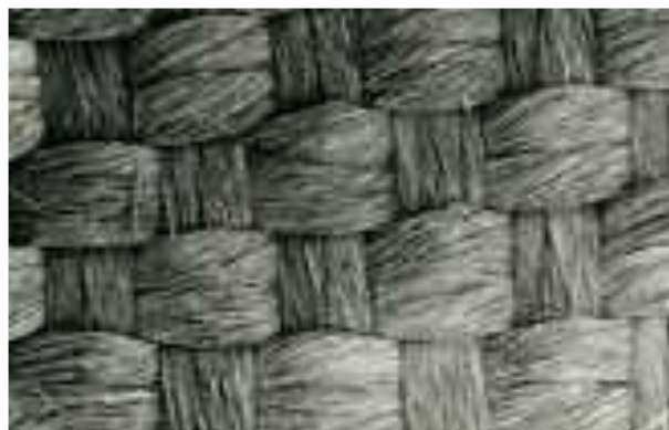
Figure III-3: Structure microscopique d'une électrode en tissu activé
