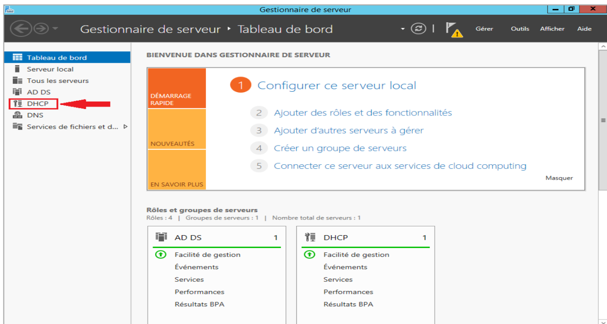
Figure III-20 : L'ajout du service DHCP sur le gestionnaire de serveur.
