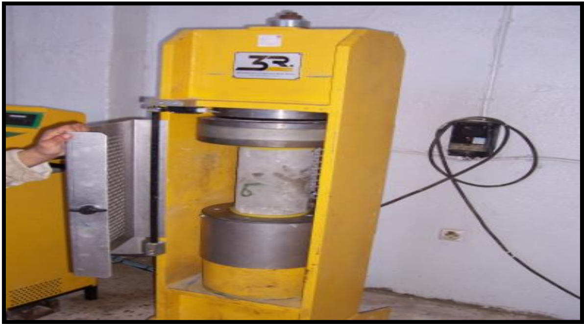
Fig V.2 : Essai de compression
