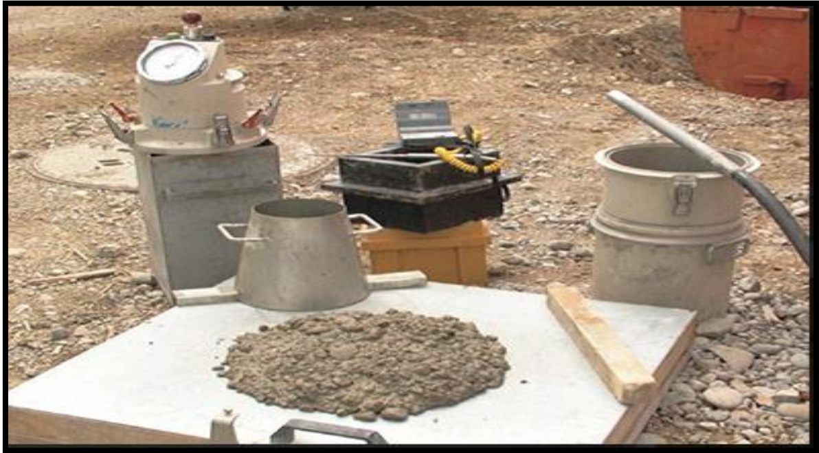
Fig V.1 : Essai d'affaissement au cône d'Abrams
