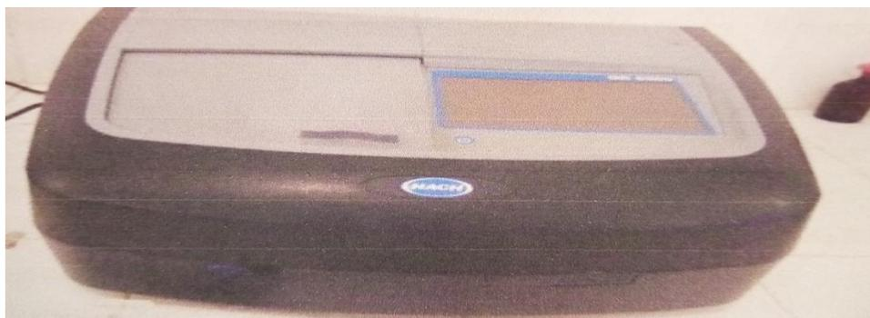
**Figure 9 :** Photo du spectrophotomètre DR6000 [4].
