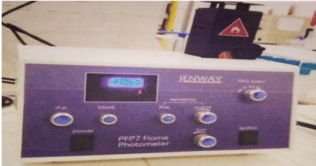
**Figure 10 :** Photo du spectrophotomètre à flamme Jenway [4].
