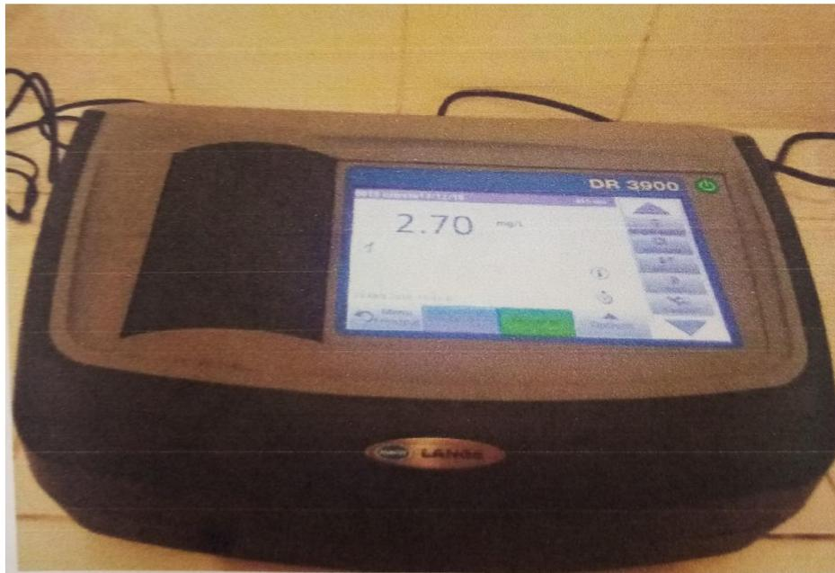
**Figure 8 :** Photo du Turbidimètre DR3900 [4].
