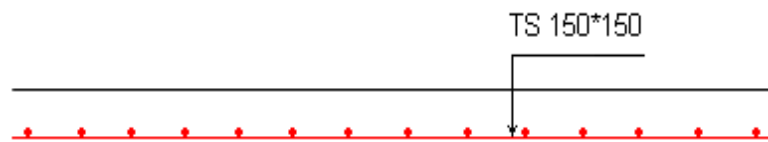
Fig III.5 : Schéma de ferrailage de la dalle de compression
